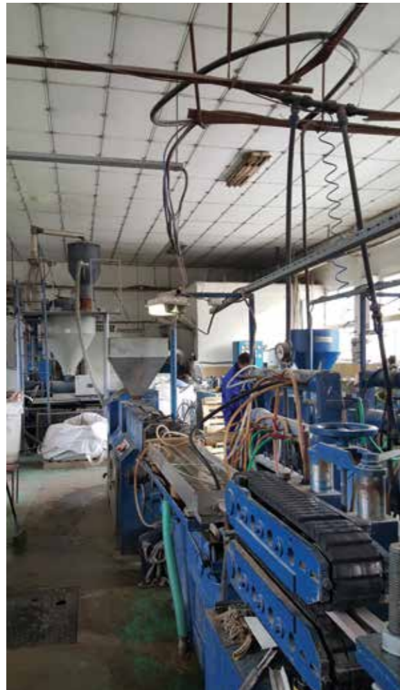
Ekstruderingsmaskinene er blant de store energiforbrukerne ved bedriften.
