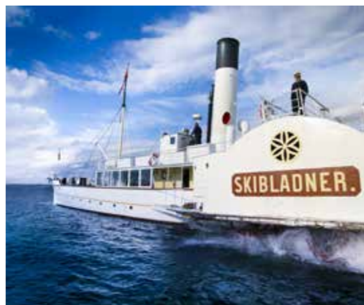
2. august 1856 ble Skibladner satt i fart. Siden da har skipet hele tiden gått i rute mellom Eidsvoll og Lillehammer. Skibladner er verdens eldste hjuldamp som fortsatt er i drift. Kjelene svir av 2500 liter olje pr dag, og dampmaskinen fra 1888 kan presse skipet opp i 14 knops fart. Det må også nevnes at Skibladner er æresmedlem i Norsk Energi. Knut Sandvold har vært styremedlem i Oplandske Dampskipsselskap i en rekke år, og har gitt vesentlige bidrag til driften av Skibladner på frivillig basis.
