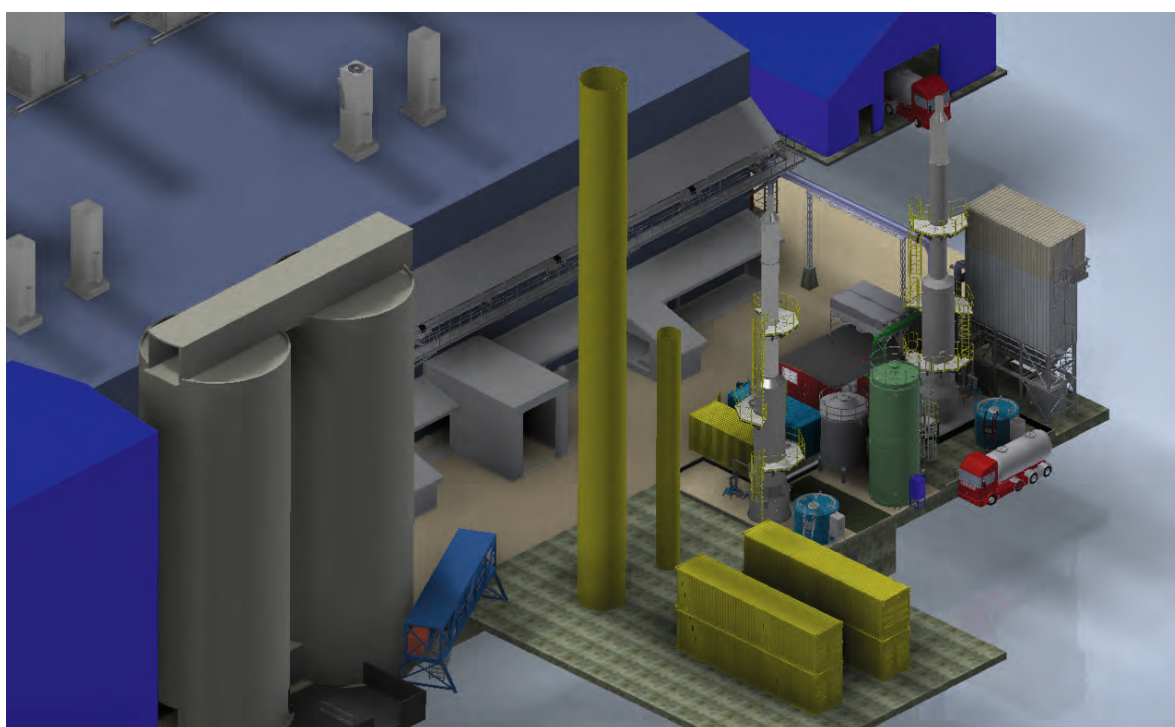
Fiven Norge AS i Lillesand har i dag et reanlegg for avgassene fra silisiumkarbidovnene. Dagens reanlegg består av et filter for partikler og to scrubbere for blant annet svoveldioksid. Dette ses til høyre på figuren. Et eventuelt fremtidig CO 2 -fangstanlegg vil bli plassert til venstre for dagens reanlegg (gul farge). Det høye tårnet er absorberen og det lave er desorberen.
