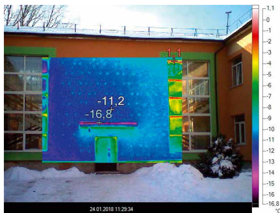
IR-kamera blir benyttet både til å identifisere tiltak og til å sjekke at gjennomførte tiltak gir den ønskede effekt.
