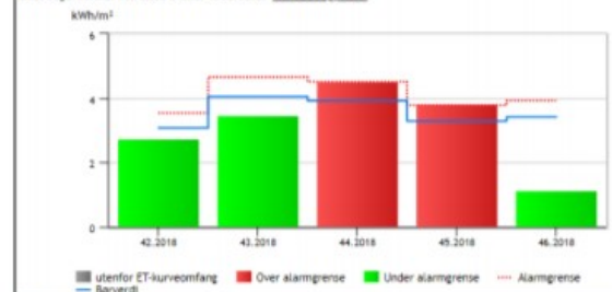
Figur 2: ET avviktsdiagram viser energiforbruket foregående fem uker. Forbruk under alarmgrensen blir grønne, mens røde søyler er uker med energiforbruk over alarmgrense på ET-kurve.
